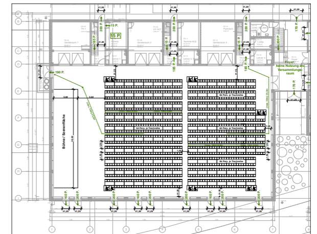
Tischreihen mit Bühne und Tanzfläche, max. 1.220 Personen: // Fluchtwegbreite 1,20m = 200 Personen // Fluchtwegbreite 1,80m = 300 Personen // Fluchtwegbreite 2,40m = 400 Personen
